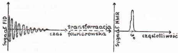
Ryc. 4. Szczyt linii rezonansowej uzyskanej po przekształceniu fourierowskim wyznacza częstotliwość Larmora ( \omega_0 )
