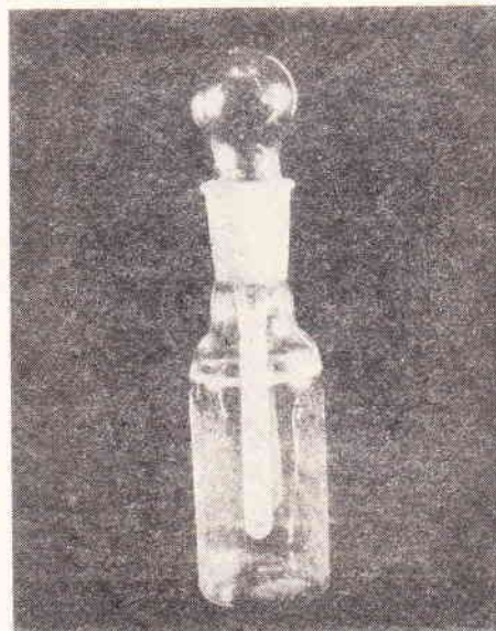
Ryc. 2. Naczynko reakcyjne — buteleczka z korkiem i umieszczona w niej bagietka szklana
